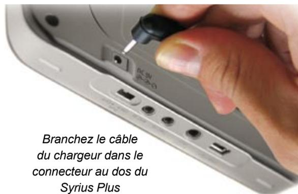
*Branchez le câble du chargeur dans le connecteur au dos du Sirius Plus*
